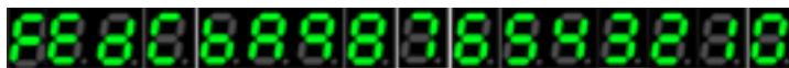
Figura 2. Secuencia de los números y letras de selección de curva girando desde el tope en sentido antihorario.
